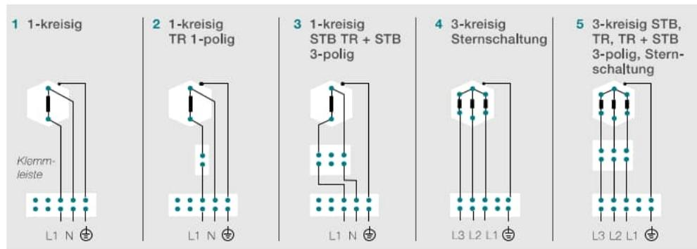
**Achtung:** Nach fachgerechtem Einbau bietet der STB einen ausreichenden Übertemperaturschutz. Der STB ist jedoch kein Schutz gegen Trockenbetrieb. Hierfür müssen Schutzsysteme wie Niveaureguliersysteme o. ä. installiert werden. Der STB schaltet auch im stromlosen Zustand und verriegelt bei Erreichen der Abschalttemperatur durch externe Wärmequellen (z. B. Solarthermie)
